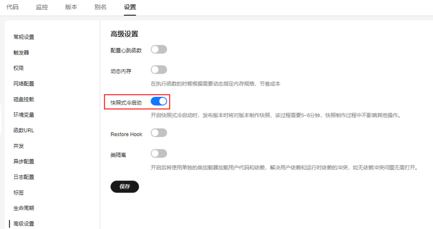
图 7-19 开启快照式冷启动
